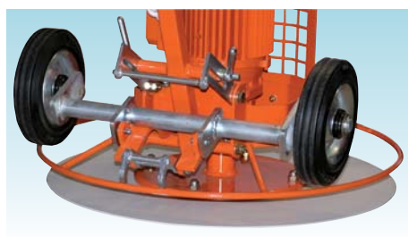
Колёсная конструкция заглаживающей машины Тип TS
