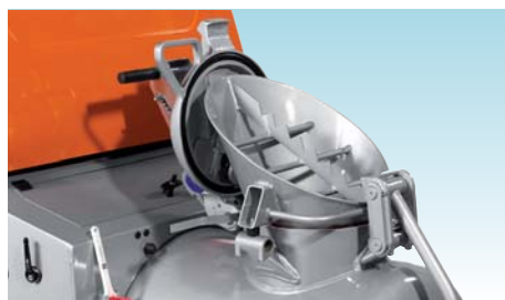
Приёмная воронка с гребешком для разрывания мешков
